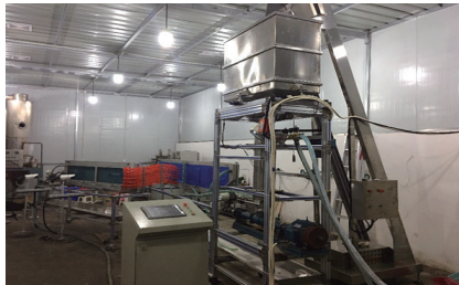
图1 新型可视化支撑剂输送物理模拟装置实物
